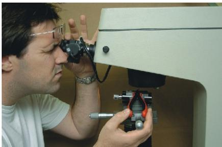
Jede schneidende Zange - selbst die extrem filigranen SMD-Zangen - verfügt über zusätzlich induktiv gehärtete Schneiden. Dazu kommt hochmoderne, opto-elektronisch überwachte Technologie zum Einsatz.
